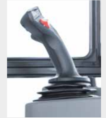
Steuerung & Bedienelemente: Reduzierte Elemente zur intuitiven Bedienung, Joystick bewegt sich ergonomisch mit dem Sitz und passt zu jeder Handgröße
