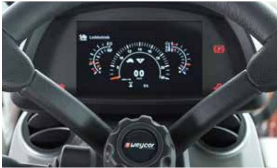
Display: Reduzierte und übersichtliche Anzeige vereinfacht die Bedienung
