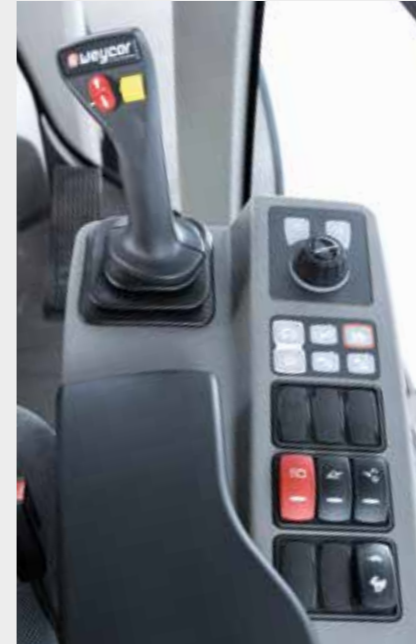
Steuerung & Bedienelemente: Reduzierte Elemente zur intuitiven Bedienung, Joystick bewegt sich ergonomisch mit dem Sitz und passt zu jeder Handgröße
